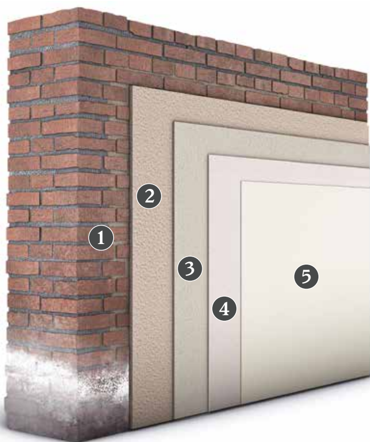
Ciclo deumidificante a base di calce idraulica NHL per muratura soggetta ad umidità di risalita
