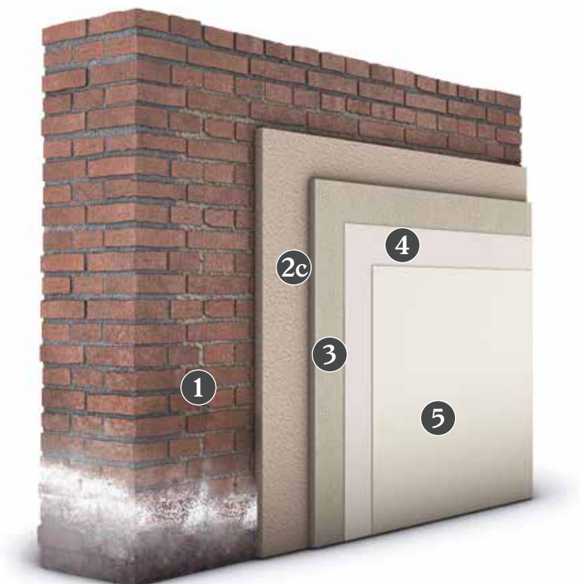
Ciclo termodeumidificante per muratura soggetta ad umidità di risalita
