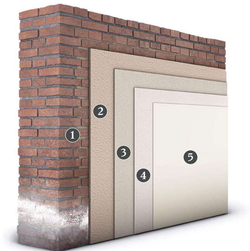
Ciclo deumidificante a base di calce idraulica NHL per muratura soggetta ad umidità di risalita
