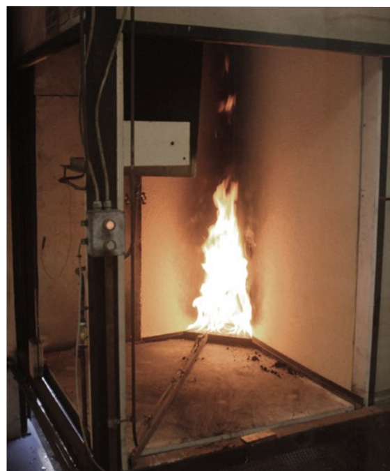
Test SBI per la determinazione della reazione al fuoco.
