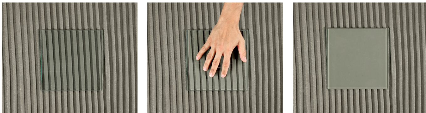
Pruebas de impregnación con H40 Gel gris. Con un simple presionado, es posible obtener un lecho macizo bajo la baldosa.
