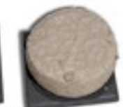
Calce idraulica naturale – NHL espansione pastiglia \approx 10\%
