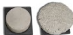
Chaux hydraulique artificielle - HL expansion pastille \approx 30 %
