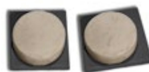
Chaux hydraulique naturelle – NHL + Pouzzolane Micronisée expansion pastille < 0,8 %
